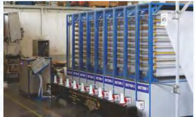
कपड़े के इनलाइन प्रशोधन के लिए विकसित प्लाज़्मा प्रणाली
