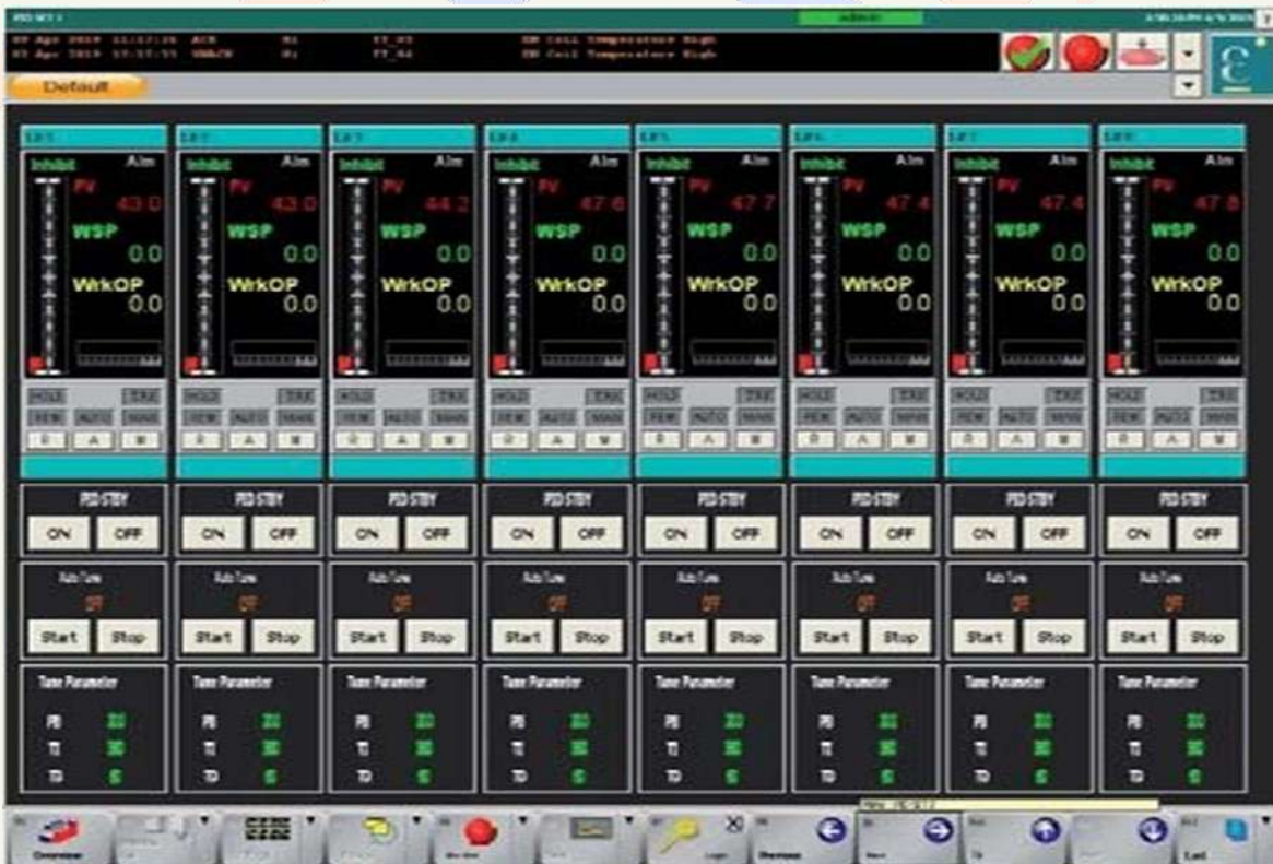
चित्र-6: लेड-लिथियम तापमान नियंत्रण स्क्रीन
